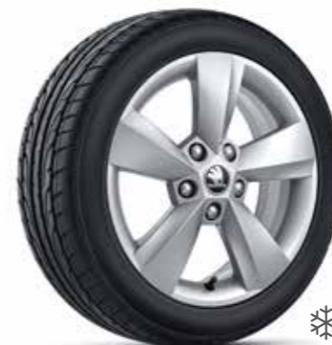
NANUQ 57A 071 496A 8Z8 Kolo z lehké slitiny 6J × 16" ET43 pro pneumatiky s rozměry 215/60 R16 (4×2, 4×4) a 225/60 R16 (4×4) ve stříbrné metalické barvě
