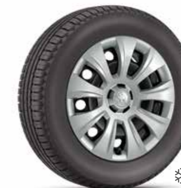
BORNEO 57A 071 456 Z31 Kryty kol pro kola s rozměry 6J × 16", čtyřdílná sada
