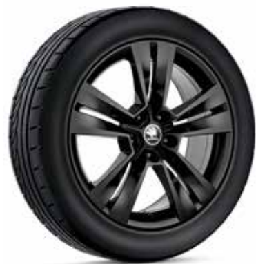
MYTIKAS 57A 071 498D FL8 Kolo z lehké slitiny 7J × 18" ET45 pro pneumatiky s rozměry 215/50 R18 (4×2) a 225/50 R18 (4×4) v černé metalické barvě
