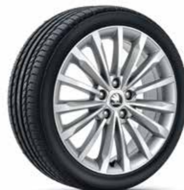
TRINITY 57A 071 498 8Z8 Kolo z lehké slitiny 7J × 18" ET45 pro pneumatiky s rozměry 215/50 R18 (4×2) a 225/50 R18 (4×4) ve stříbrné metalické barvě, broušené
