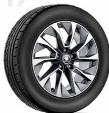
ARONIA 57A 071 497E HA7 Kolo z lehké slitiny 7J × 17" ET45 pro pneumatiky s rozměry 215/55 R17 (4×2) a 225/55 R17 (4×4) v antracitové metalické barvě, broušené
